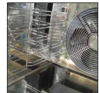
Interno cella con struttura reggigriglie e fondo raggiato
